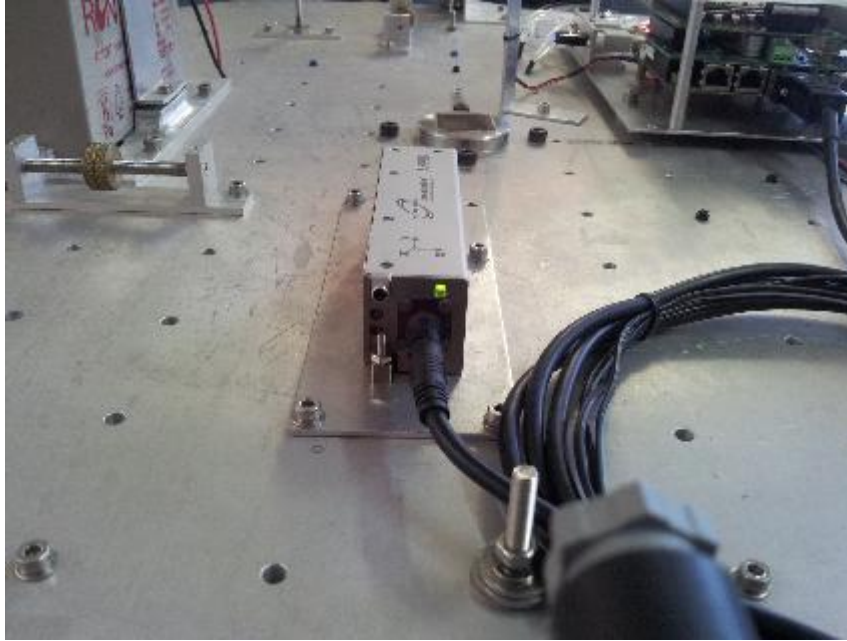
Figura B.14 – LED verde: indicação de sensor em modo de operação.
